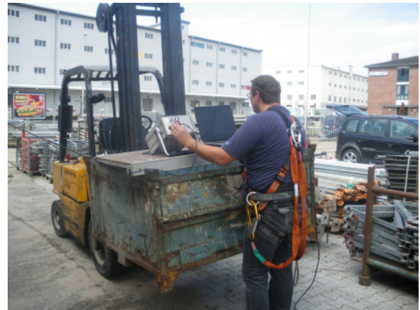
Abb 4: Messung der Seilkräfte
